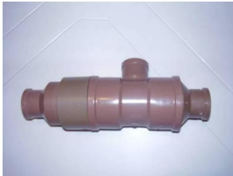
Figura 7 Corpo da bomba com válvulas coladas
