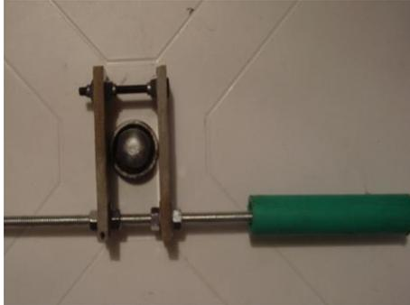
Figura 9 Êmbolo com sistema de transmissão para ser ligado ao eixo da roda
