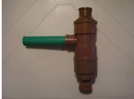
Figura 5 corpo da bomba com as válvulas de entrada e saída
