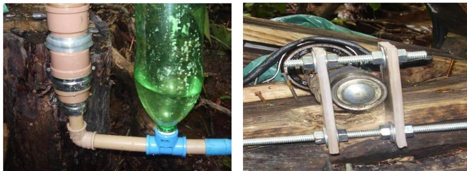
Figura 12. Detalhes da fixação da bomba e do eixo
