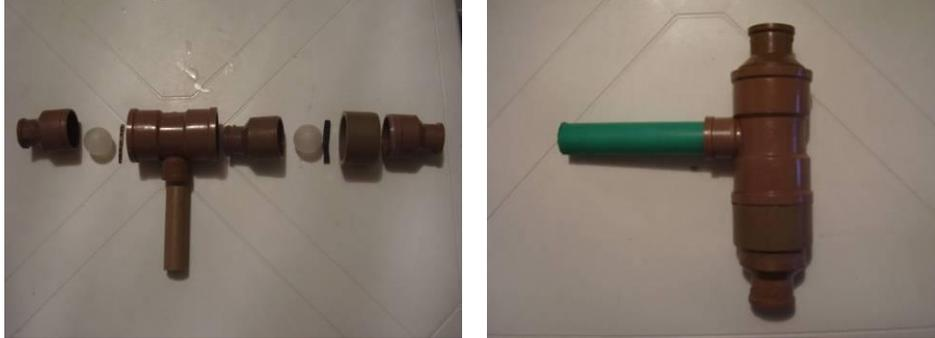
Figura 4 bomba d'água e seus componentes básicos e na sequência bomba montada
