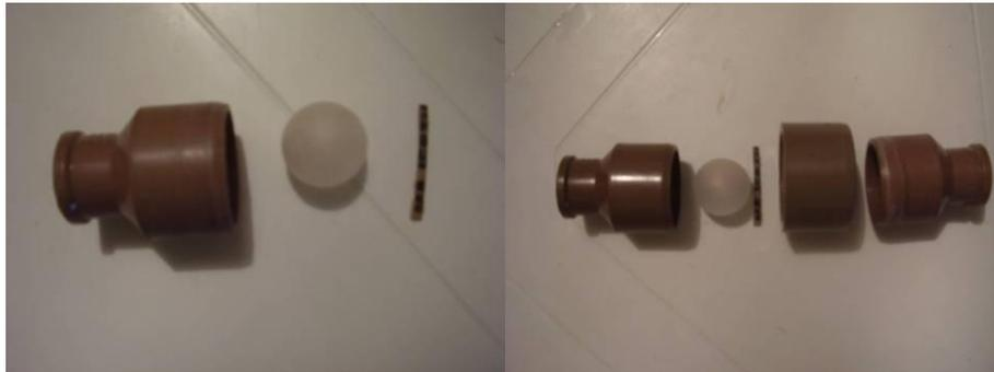
Figura 6 Válvulas de entrada e saída de água desmontadas
