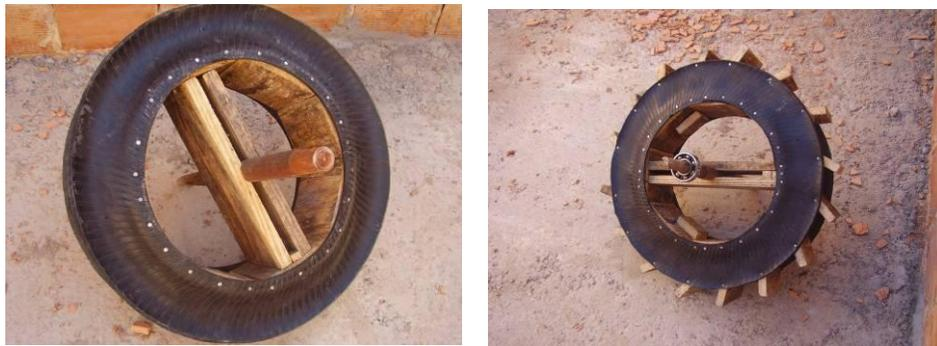
Figura 11 Processo de montagem da roda d'água
