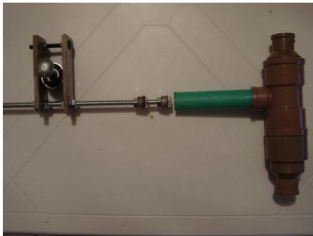
Figura 10 Bomba d'água com sistema de transmissão para ligar ao eixo roda
